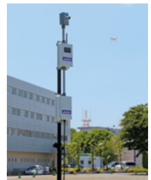
ドローン対策の音響センサー
